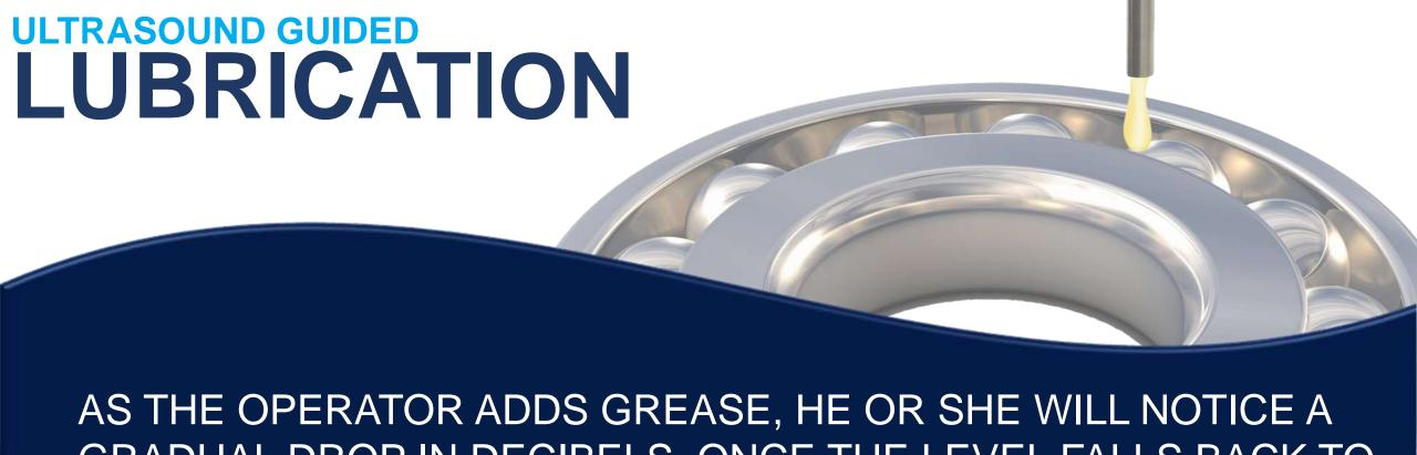
AS THE OPERATOR ADDS GREASE, HE OR SHE WILL NOTICE A GRADUAL DROP IN DECIBELS. ONCE THE LEVEL FALLS BACK TO THE BASELINE, **THE BEARING IS SUFFICIENTLY LUBRICATED**.
